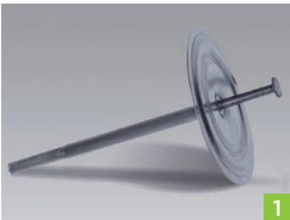
1. Zur Befestigung von Topdec Decken-Dämmplatten an Betondecken- und wänden eignen sich übliche Tellerdübel, bzw. Dämmstoffhalter oder -schrauben mit einem Tellerdurchmesser ab 60 mm.
