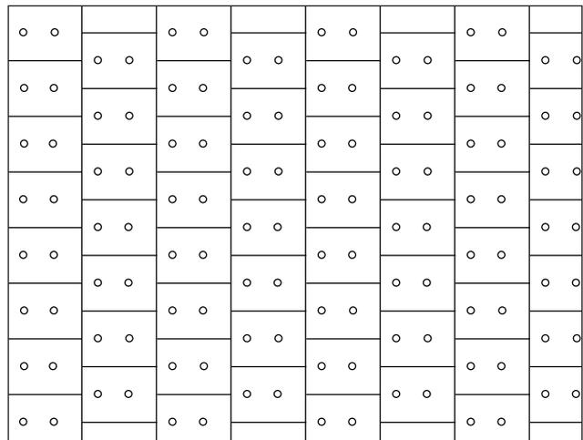
Montage dicht gestoßen im Verband und zwei Dübel in der Plattenfläche
