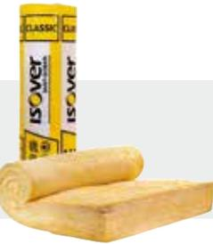
**Wärmedämmfilz.** Wärmedämmfilz zur Dämmung der obersten Geschoßdecke durch einfaches Aufrollen in ungenutzten, nicht begangenen Dach- und Schließböden. Gehwege können einfach durch Auslegen von Topdec Dämmblock zwischen den Filzen angelegt werden.
