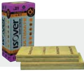
**ULTIMATE WSP-031.** Die Wärmeleitfähigkeit von 0,031 W/m·K ermöglicht die bestmögliche Dämmung von Wandkassetten bei gleichzeitiger thermischer Trennung von Innen- und Außenblech durch eine 40mm überstehende Dämmschicht. Die durchgehend hydrophobierten ULTIMATE Hochleistungs-Steinwolle-Dämmplatten sind an einer Längskante mit einem Einschnitt versehen, der den Kassettensteg aufnimmt. Die eingeschnittene Seite ist auf der Glasvlieskaschierung mit einer Strichmarkierung gekennzeichnet.
