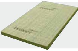
**Metac FLP 1 Duratec.** Flachdach-Dämmplatte aus Steinwolle für die Wärme- und Schalldämmung sowie für den Brandschutz von einschaligen Flachdächern. Die Platten werden ein- oder zweilagig verlegt und sind durchgehend hydrophobiert ausgestattet. Die Oberseite der zweischichtigen Flachdach-Dämmplatte mit verdichteter Deckschicht ist durch eine Markierung gekennzeichnet. Geeignet für Flachdach-Aufbauten mit Extensivbegrünung bis 10 cm Aufbauhöhe.
