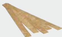
**Akustic ES 1.** Randdämmstreifen aus Glaswolle für die Trittschalldämmung von schwimmenden Nass- sowie Trockenestrichen. Lückenlos um die komplette Estrichfläche verlegt, gewährleisten sie die schalltechnische Entkopplung des Estrichs.
