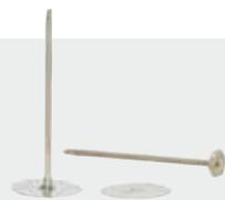
**Dämmstoffhalter Metall.** Metalldämmstoffhalter mit glattem Metallteller DN 80mm zur Verwendung bei ISOVER Kellerdeckendämmplatten und bei Fassadendämmplatten. Die Dämmstoffhalter kommen dort zum Einsatz, wo die Nichtbrennbarkeit der Einzelkomponenten gefordert wird.
