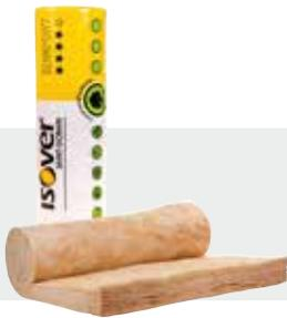
**Uniroll Plus.** Universell einsetzbarer Mineralwolle-Klemmfalz aus Recyclingglas, nachhaltig produziert mit 100% Ökostrom und mit pflanzlichem Bindemittel, zur Wärme- und Schalldämmung zwischen Sparren und in Holzriegelkonstruktionen. Querstrichmarkierung für einen effizienten Zuschnitt und hohe Faserverfilzung für eine verbesserte Klemmwirkung bei Arbeiten über Kopf wie z.B. Dämmung von Dachschrägen oder Zangendecken.
