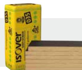
**Kontur FSP 1-035.** Einseitig mit schwarzem Glasvlies kaschierte und durchgehend hydrophobierte, formstabile Fassaden-Dämmplatte aus Glaswolle zur effizienten außenseitigen Wanddämmung von vorgehängten, hinterlüfteten, nichttransparenten Fassaden.
