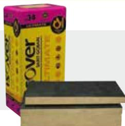
**ULTIMATE FSP-034.** Die einseitig mit schwarzem Glasvlies kaschierte und durchgehend hydrophobierte Fassadendämmplatte wird zur außenseitigen Wärmedämmung von Außenwänden bei hinterlüfteten, nicht-transparenten bzw. opaken Fassadenbekleidungen, insbesondere bei Fassadenbekleidungen mit offenen Fugen, ohne Beschränkung bei der Gebäudehöhe eingesetzt.
