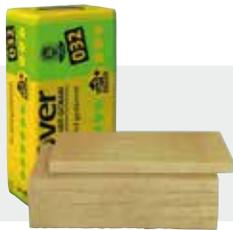
**Kontur KP 1-032.** Durchgehend hydrophobierte, formstabile, einseitig mit hellem Glasvlies kaschierte Mineralwolle-Dämmplatte für Dachausbau, Holzrahmenbau, Trockenbau und hinterlüftete Fassade. Die hohe Flexibilität und Formbeständigkeit der Dämmplatten ermöglichen eine passgenaue Verarbeitung.
