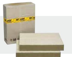
**Topdec Universal.** Die Topdec Universal Decken-Dämmplatte aus Steinwolle mit einseitigem anorganischen Haftvermittler bietet wertvollen Wärmeschutz, vorbeugenden Brandschutz sowie effektiven Schallschutz. Deckenoptik: Ohne optischen Anspruch bleibt die Platte unbehandelt, bei untergeordnetem optischen Anspruch wird farbbeschichtet und bei geringem optischen Anspruch gespachtelt.
