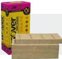
**ULTIMATE KP-034.** Einseitig mit Schutz-Glasvlies kaschierte und durchgehend hydrophobierte Fassadendämmplatte aus ULTIMATE. Zur außenseitigen Wärmedämmung von Außenwänden bei hinterlüfteten Fassadenbekleidungen sowie zur Wärme- und Schalldämmung im zweischaligen Mauerwerk mit und ohne Luftschicht oder bei Gebäudetrennwänden. Bei Lieferung in der hinterlüfteten Fassade muss die Platte mit dem Glasvlies in Richtung Wand angebracht werden.
