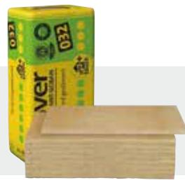
**Akustic EP 1.** Hochelastische Trittschall-Dämmplatte aus Glaswolle für die unübertroffene Schalldämmung unter schwimmenden Mörtel- und Fließestrichen. Für Wohn- und Büroräume, Flure etc. mit Auflast bis 5 kPa. Besonders geeignet für die schalltechnische Ertüchtigung von Holzdecken in der Sanierung.
