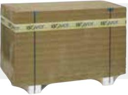
**Metac FLP 2 Duratec.** Flachdach-Dämmplatte aus Steinwolle mit verdichteter Deckschicht und Vlieskaschierung. Mit einer Punktlast  $\geq 800 \text{ N}$  ist die ISOVER Metac FLP 2 besonders geeignet bei erhöhten Anforderungen durch zusätzliche Auflasten wie z. B. Solaranlagen oder Flachdach-Aufbauten mit Extensivbegrünung bis 10 cm Aufbauhöhe.
