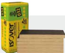
**Kontur FSP 1-032.** Einseitig mit schwarzem Glasvlies kaschierte, und durchgehend hydrophobierte, formstabile Fassaden-Dämmplatte aus Glaswolle zur besonders effizienten außenseitigen Wanddämmung von vorgehängten, hinterlüfteten, nichttransparenten Fassaden.
