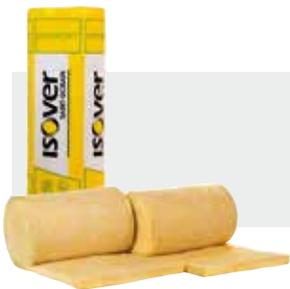
**Multi-Kombi Passivhaus Filz Duo.** Zur zusätzlichen Wärme- und Schalldämmung von Holzrahmen-Konstruktionen, als zweite Lage Wärmedämmung bei Dachschrägen und im Innenbereich, wo das Gefach die lichte Weite von 59 bis 59,5 cm aufweist.
