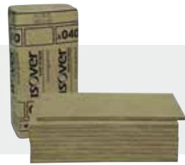
**Akustic EP 3.** Universell einsetzbare, hochverdichtete Trittschall-Dämmplatte aus Steinwolle für gute Trittschalldämmung unter schwimmenden Mörtel- und Fließestrichen für Auflast bis 10 kPa, bis 20 kPa ab 30 mm. Z.B. für Supermärkte, Lagerräume, Werkstätten etc. Auch geeignet für schwimmende Gussasphaltestriche bis 2,0 kPa (bis 30 mm).
