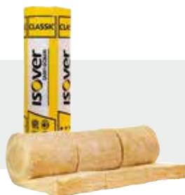
**Quattro.** Als zweite Dämmlage, z.B. als Dämmung der Installationsebene im Leichtbau, bei Wärme- und Schalldämmung von Holzfußböden zwischen den Polsterhölzern. Schnelle, einfache und fugendichte Montage durch Bahnbreite von 41,5 cm, abgestimmt auf das Rastermaß von 40 cm bei Gipskarton-Metallunterkonstruktionen.
