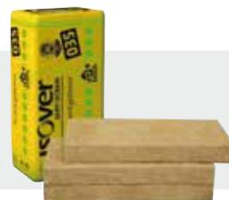
**Kontur KP 1-035.** Durchgehend hydrophobierte, formstabile, einseitig mit hellem Glasvlies kaschierte Mineralwolle-Dämmplatte für Dachausbau, Holzrahmenbau, Trockenbau und hinterlüftete Fassade. Die hohe Flexibilität und Formbeständigkeit der Dämmplatten ermöglichen eine passgenaue Verarbeitung. Bei Anwendung in der hinterlüfteten Fassade wird die Platte mit dem Glasvlies in Richtung Wand angebracht.
